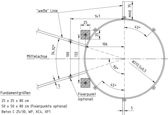
Betonstahl Bst. 500 A; Stahl / Beton Überdeckung c≥5 cm
